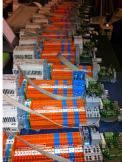
Oben: Variante Schrankeinbau mit DIN Schiene +Klemmen.
